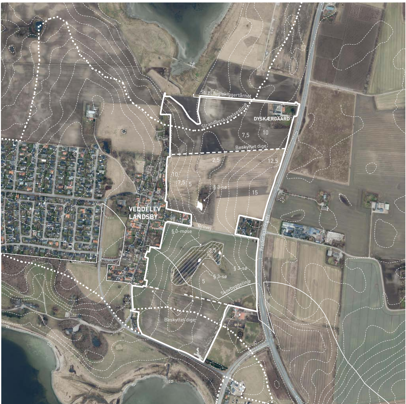
Fig.2. Lokalplanområdets afgrænsning, vist med kraftig, hvid streg. Det ses, hvordan terrænet falder ned mod Roskilde Fjord på begge sider af Brovej. De stiplede linjer er højdekurver, som viser højden over havoverfladen. © SDFE og Roskilde Kommune.
